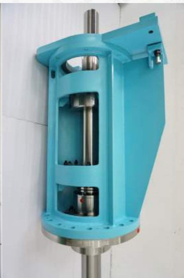
搅拌机架、搅拌桨、联轴器、轴及密封系统
