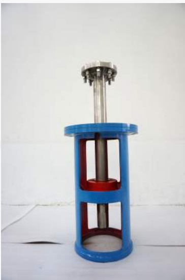
搅拌机架、搅拌桨、联轴器、轴及密封系统
